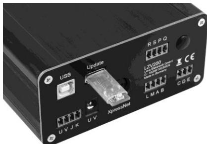
Erst jetzt schalten Sie den Strom wieder ein (steckbare Schraubklemme U,V,J,K wieder einstecken). Die untere LED auf der Frontseite der LZV200 blinkt.
