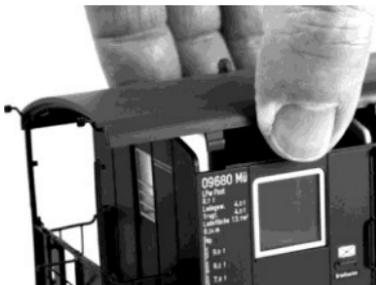
Drücken Sie nach innen gegen die Dachkante und heben Sie das Dach an.
