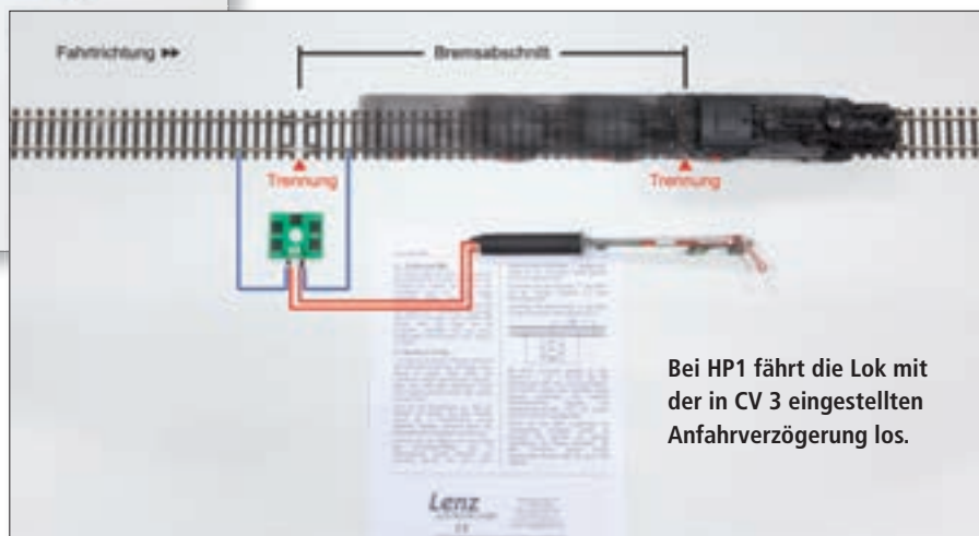
Oben: Der ABC-Baustein BM1 – mit gerade einmal 27,5 x 21,5 mm passt er auch bei beengten Platzverhältnissen unter der Anlage noch irgendwohin.
