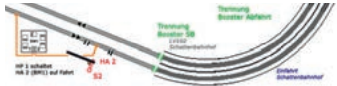
Verdrahtungsschema für Einfahrtsignal S2 und BM1.
